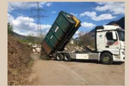
2. Anlieferung Baum- und Strauchschnitt-> wird zerkleinert und mit Bioabfall in der Halle vermischt
