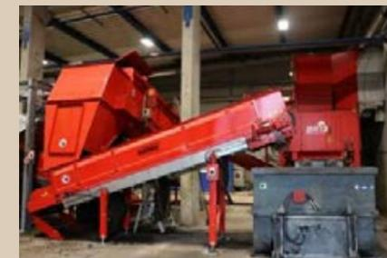
3. Material gelangt zu einem Sackaufreißer zur Aussiebung der Störstoffe (Fehlwürfe)-> werden rechts in den Container abgeworfen-> dieser Siebrest kommt direkt in die Verbrennung
